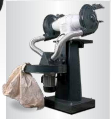
Abb.: GZ 25DD mit optionalen Schleifscheiben
