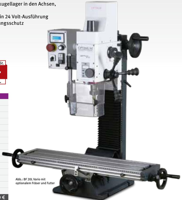
**OPTi drill® MH 20V / MH 20VL / MH 20VLD - Stabile Bohr-Fräsmaschinen mit manuellem Pinolenvorschub**
