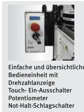
Einfache und übersichtliche Bedieneinheit mit Drehzahlanzeige Touch- Ein-Ausschalter Potentiometer Not-Halt-Schlagschalter
