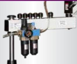
› Öl und Wasser werden von der Luft getrennt, um den normalen Betrieb des Motors zu gewährleisten und die Lebensdauer des Motors zu verlängern
