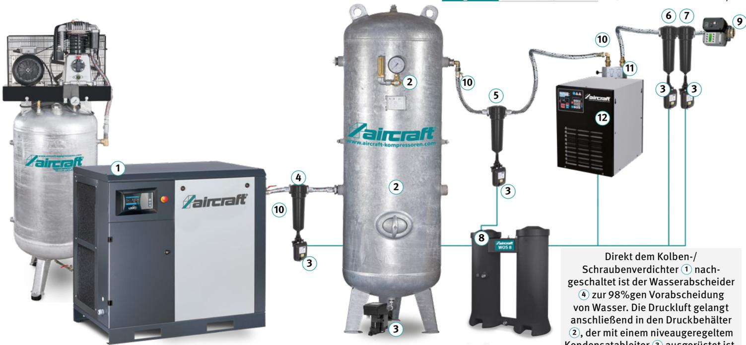
Direkt dem Kolben-/Schraubenverdichter ① nachgeschaltet ist der Wasserabscheider ④ zur 98%igen Vorabscheidung von Wasser. Die Druckluft gelangt anschließend in den Druckbehälter ②, der mit einem niveaugeregeltem Kondensatableiter ③ ausgerüstet ist. Vom Behälter aus geht es über den Feinfilter ① in den Druckluft-Kältetrockner ⑫.
