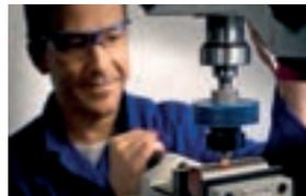
Beim Thermbohren wird durch Reibungshitze aus dem vorhandenen Material spanlos eine verdrehsichere Buchse geformt und dann ein Gewinde eingebracht.
