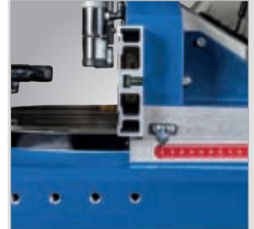
▶ Anschlag stufenlos verstellbar
