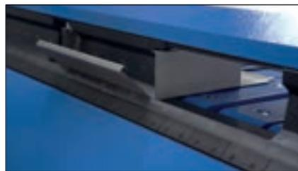
Dank der schwenkbaren Oberwange können komplexe Teile mit umlaufenden Biegungen mit 125mm Seitenhöhe und langen Profilseiten ohne Aufwand schnell und komfortabel hergestellt werden
