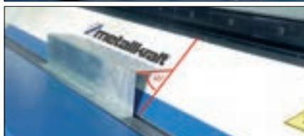
Die 45° Geometrie an beiden Seiten der drehbaren Oberwange ermöglicht die höchst flexible und einfache Herstellung von schmalen Teilen
