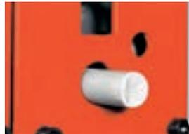
▶ Profilstahlschere / Rundstahlmesser
