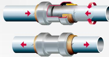
Den Fitting oder das Rohr unter leichtem Drehen und gleichzeitigem Drücken in axialer Richtung bis zur markierten Einstecktiefe einschieben
