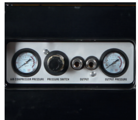
› Zwei Einhand-Schnellkupplungen für das Betreiben von Druckluftwerkzeug
