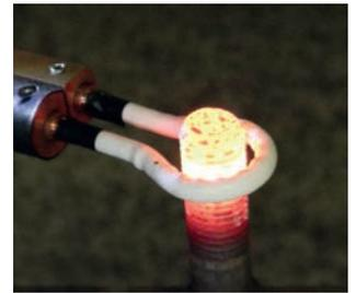
› Erwärmen eines Gewindebolzens mit der wassergekühlten Spule
