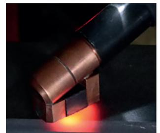
› Erwärmen eines Bauteils mit der Fokusspule schräg
