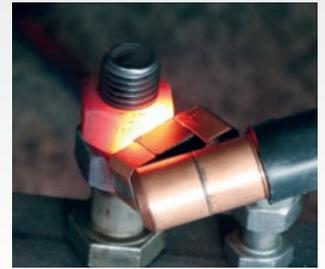
› Erwärmen einer Mutter mit der Fokusspule schräg
