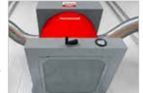
Integrierte Hebevorrichtung für den Filterwechsel
