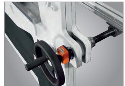
Verstellung des Hinteranschlags über Handrad mit Zählwerk
