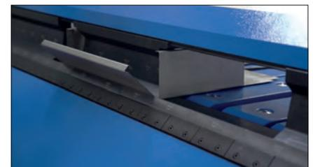
Dank der schwenkbaren Oberwange können komplexe Teile mit umlaufenden Biegungen mit 125mm Seitenhöhe und langen Profilseiten ohne Aufwand schnell und komfortabel hergestellt werden
