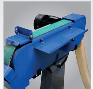
Planschleiftisch mit Schleifband
