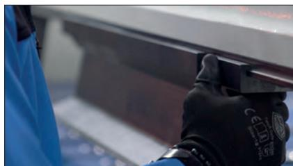
Sehr schnelle Rüstzeiten durch pneumatische Werkzeugklemmung der segmentierten Oberwerkzeuge (Option)
