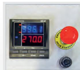
▶ Einfache Bedienung, mit digitaler Anzeige für aktuelle Biegewerte und zum Setzen der Parameter
