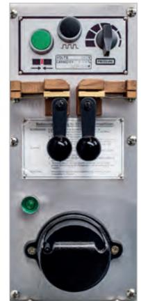
alle Modelle mit integrierter Bandschweißeinheit
