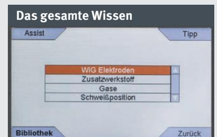
► Eine Bibliothek ermöglicht kinderleichtes, schnelles und sicheres Einstellen bei einfachen und komplexen Schweißaufgaben. Die Einstellung erfolgt über die Auswahl des Grundwerkstoffes und die Materialstärke.
