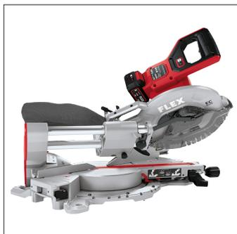
Schwenksegment bis 48° L/R. Mit Winkelanschlag-Stopper 0°, 22,5°, 33,9°, 45° L/R für Hinterschnitte, Winkelschnitte und Schifterschnitte
